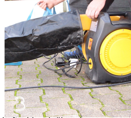
3 Luftschlauch über den Gebläsestutzen ziehen
